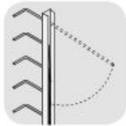
Stabox® Rückbiegeanschluss einreihig
